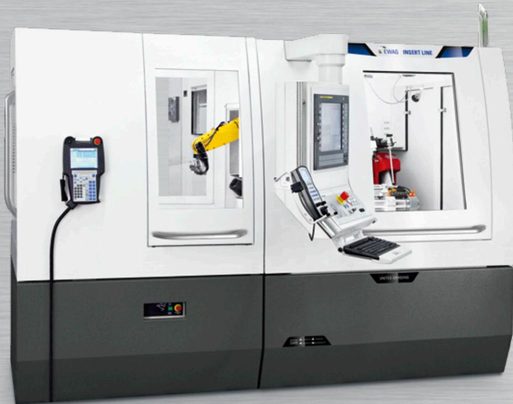
INSERT LINE – High Speed Machining HSM mit EWAG-Drehtonnenlösung und FANUC-6-Achs-Roboter für den mannarmen Mehrschichtbetrieb.
