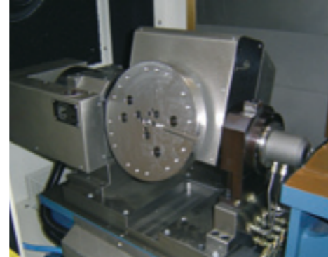
Doppel-NC-Teilapparat für 5-achsiges Profilschleifen
