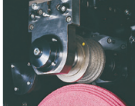
CD-Abrichtgerät auf dem Schleifkopf, Einspindelauführung (V-Achse)
