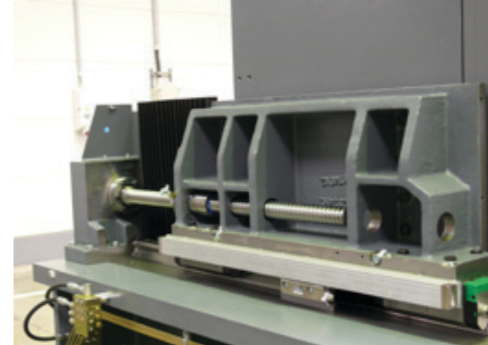
Z-Achse mit Linearführungssystem, geschliffenem Kugelgewindtrieb und direktem Linearmesssystem
