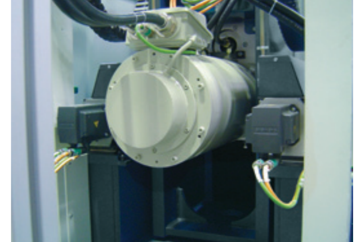
Z-Achse mit Parallel-Achsantrieb für erhöhte Steifigkeit (Option)
