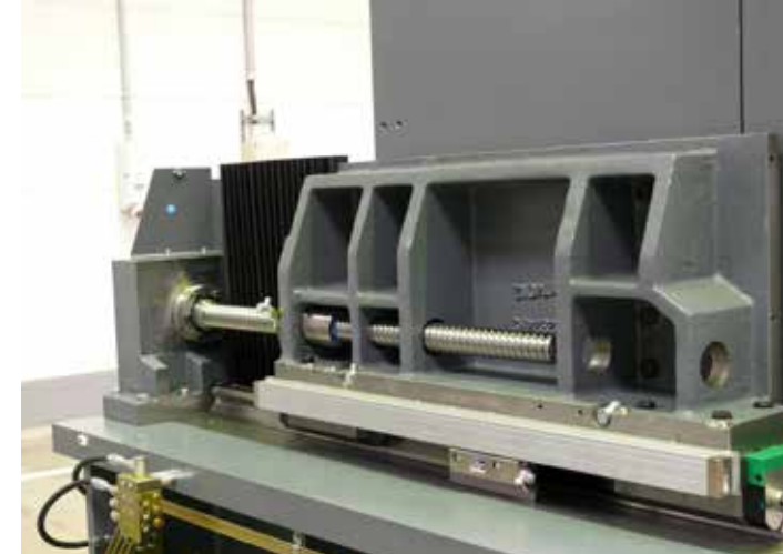
Z-Achse mit Linearführungssystem, geschliffenem Kugelgewindetrieb und direktem Linearmesssystem
