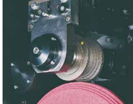
CD-Abrichtgerät auf dem Schleifkopf, Einspindelausführung (V-Achse)
