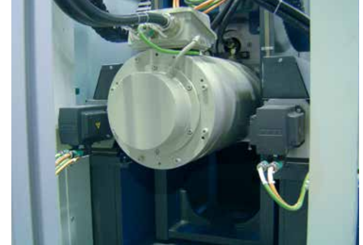
Z-Achse mit Parallel-Achsenantrieb für erhöhte Steifigkeit (Option)
