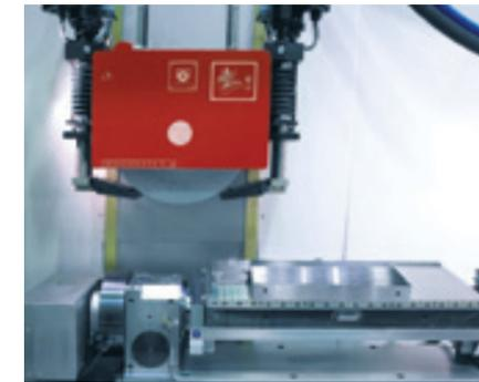
**NC-schwenkbare Magnetspannplatte**, Schwenkbereich +/- 30°, Teilungsgenauigkeit bis +/- 1"
