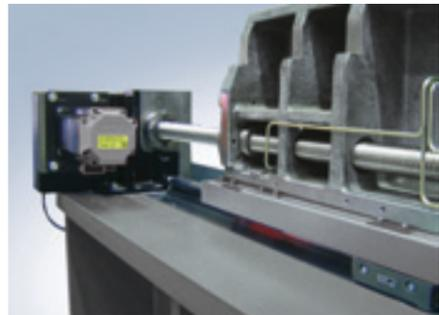
**Z-Achse** mit Linearmesssystem
