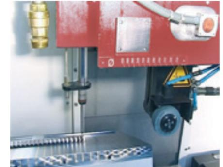
**Messtaster**, in den Arbeitsraum einfahrbar, bis 2 ½ Achsen und einer Messgenauigkeit von +/- 1µm, Schleifeinrichtung für kleine Schleifscheiben (Ø50...100)
