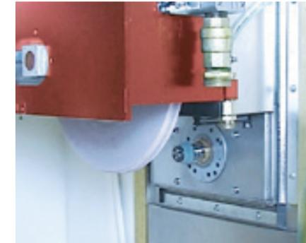
**Horizontal-Zusatzspindel**, automatisch in den Arbeitsbereich einfahrbar, min. Schleifscheibendurchmesser 30mm zum Hinterschleifen von Räumnadeln
