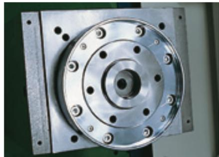
**Einschubspindel** mit Plananlage für reproduzierbare Schleifscheibenlagen
