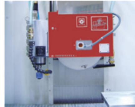
**Vertikal-Zusatzspindel** für universellen Einsatz im Werkzeugbau, Antriebsleistung bis 6 kW, Drehzahl bis 90.000 min<sup>-1</sup>
