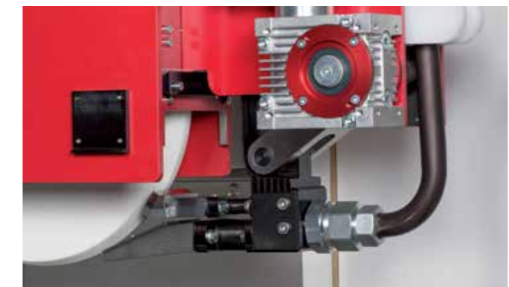
Neue Form der Schleifscheibenreinigung, mit neuentwickelter Düsenachsführung, 30% weniger Schleifscheibenverbrauch, 30-40 bar Düsendruck
