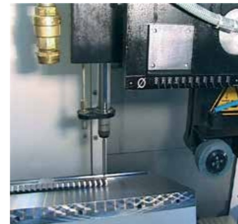
Messtaster , in den Arbeitsraum einfahrbar, Messgenauigkeit \pm 1 \mu\text{m}
