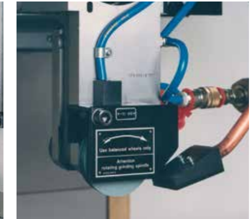
Horizontal-Schleifarm für Schleifscheibendurchmesser 50 -100 mm; bis 20.000 \text{ min}^{-1}
