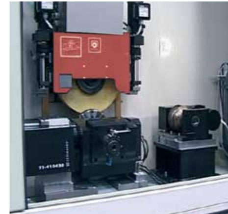
NC-Teilapparat , 1- oder 2-achsig; Teilungsgenauigkeit bis \pm 1''
