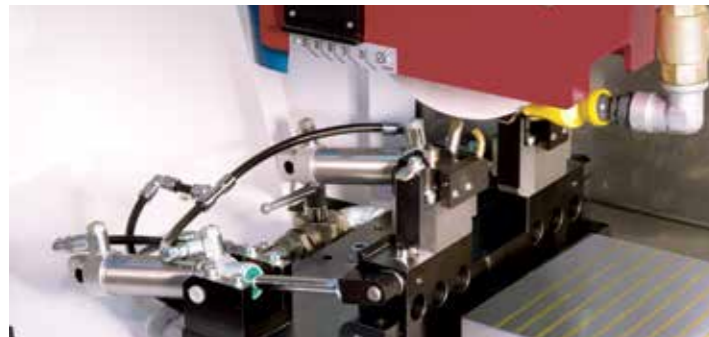
Schwenkabrichter für das Umfangs-, Seiten- und Profilabrichten. Durch pneumatische Betätigung können Schleifscheibe und Schutzhaube nicht mit dem Abrichter kollidieren.
