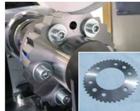
Umform- und Schneidwerkzeug für Kühlerlamellen
