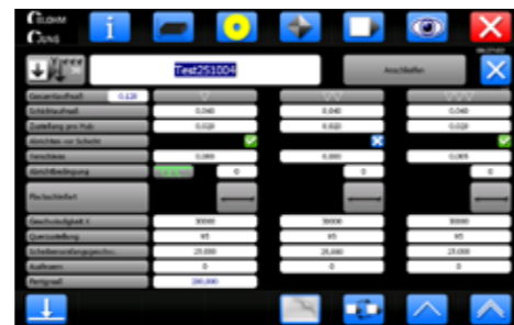
3-Schicht-Automatikzyklus: Schruppen, Schlichten, Feinschlichten mit integrierten Abrichtzyklen. Nur wenige Parameter beschreiben den kompletten Zyklus.
